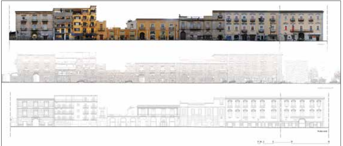
Figura 3: S. Maria C.V., Corso A. Moro. Elaborati grafici a confronto estratti dal modello nuvola di punti mobile mapping; proiezione bidimensionale e nuvola di punti della cortina urbana.
