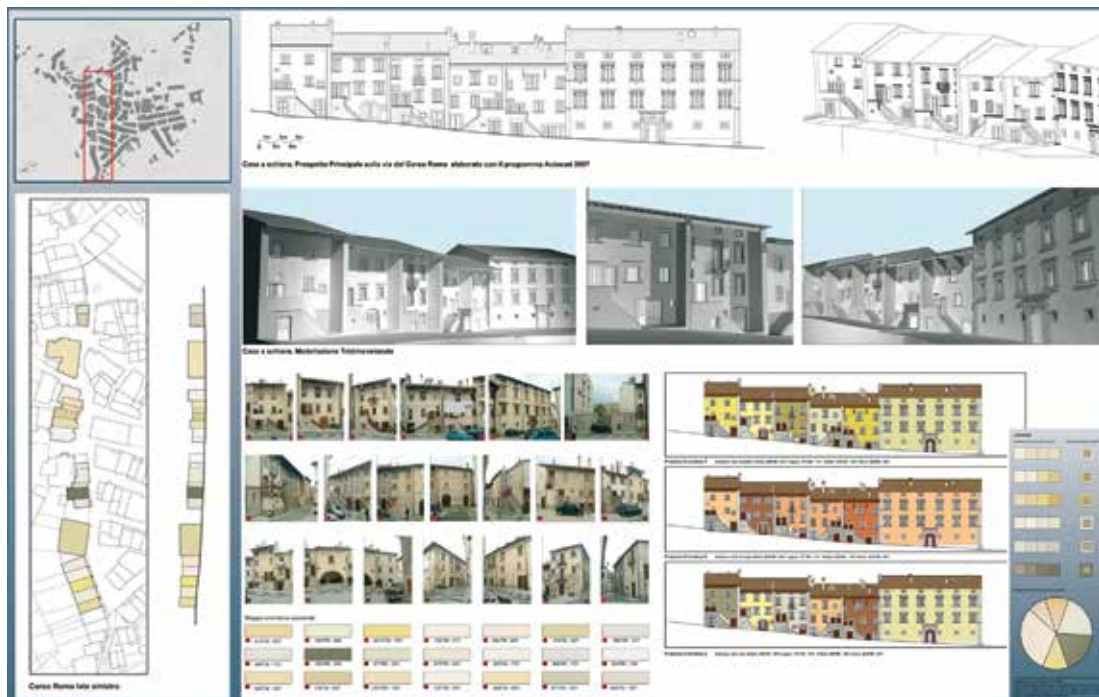
Figura 9: Elaborati grafici ed Analisi Materico-cromatica di un brano del Centro Storico di Pescocostanzo: La cortine edilizie su Corso Roma. Elaborazione, modellazione e rilievi a cura di Carla Ramunno.
