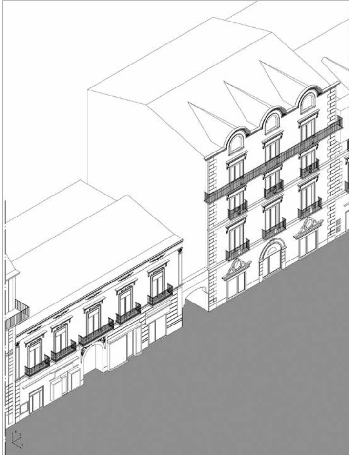
Figura 3: S. Maria C.V., Corso A. Moro. Elaborati grafici a confronto estratti dal modello nuvola di punti mobile mapping; proiezione bidimensionale e nuvola di punti della cortina urbana.
