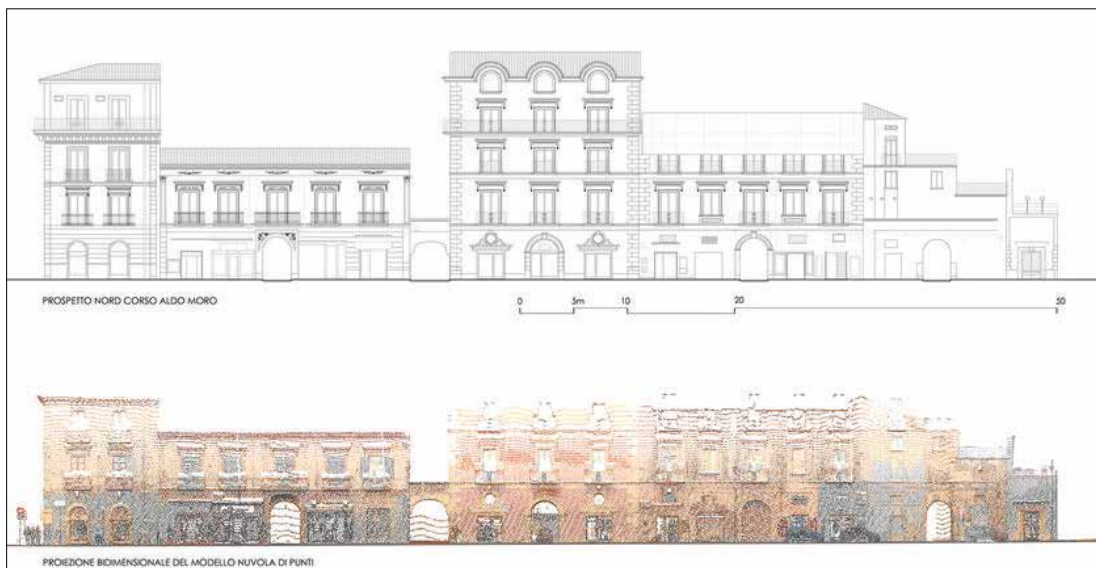
Figura 2: S. Maria C.V., Corso A. Moro. Elaborati grafici a confronto estratti dal modello nuvola di punti mobile mapping. Dall'alto ortofotopiano, nuvola di punti e proiezione bidimensionale della cortina urbana.
